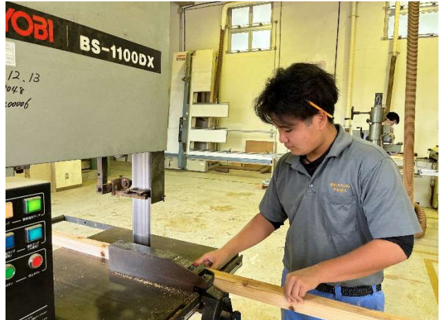
帯ノコ（機械）で加工しているところ
